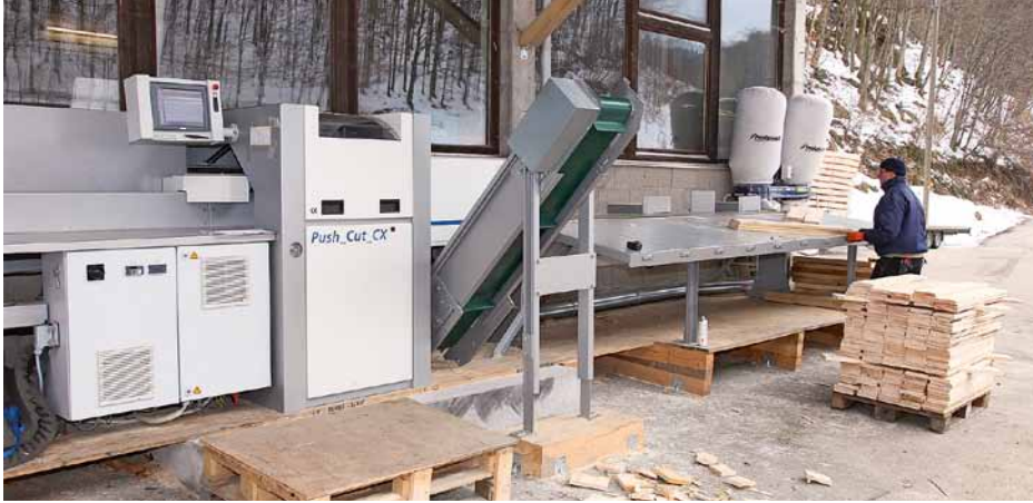
Die neue Push_Cut_CXII in der Kisten- und Palettenfabrik Ramsteiner – gestapelt wird manuell
