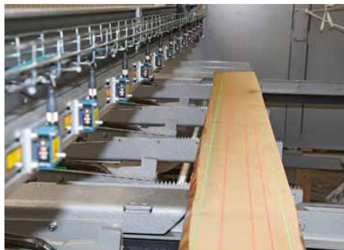
Präzise Vermessung der Werkstücke mittels Lasersensoren von oben im Quertransport
