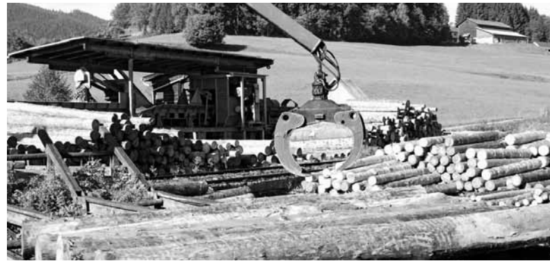
Der Sortierkran ergreift Stämme mit geeignetem Zopfdurchmesser
