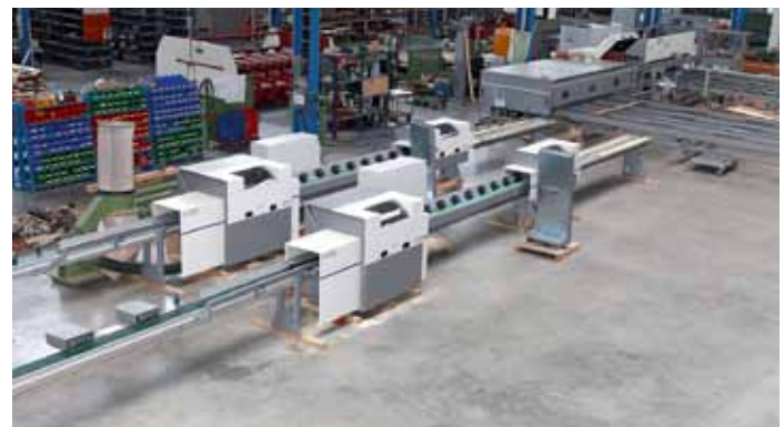
Die aufgetrennten Werkstücke werden von zwei Kapplinien vom Typ C11_MKL weiterverarbeitet – eine dritte Kapplinie kann nachgerüstet werden
