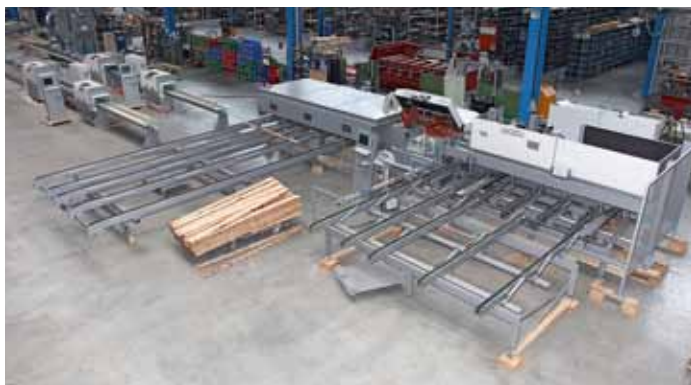
Produktionsanlage für Massivholzkomponenten: Im Vordergrund sind die automatische Beschickung AB920 und die Auftrennsäge CGL zu sehen
