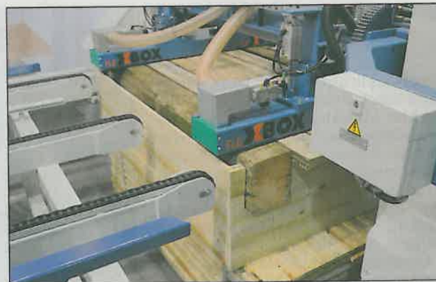
Abbildung 28 Die „Flexbox“ von Sicko hebt und stapelt auch Lagen mit geschüsselten und verdrehten Brettern störungsfrei.
