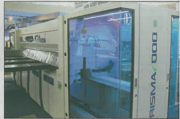
Die Plattensäge „Prisma 6000 Ecotech“ von Giben arbeitet mit Energierückgewinnungsmodulen.
