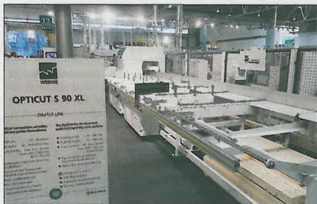
Die Schiebersäge „Opti Cut S 90 XL Superdrill“ von Weinig vereint die Arbeitsgänge Kappen, Bohren und Fräsen in einer Maschine.
