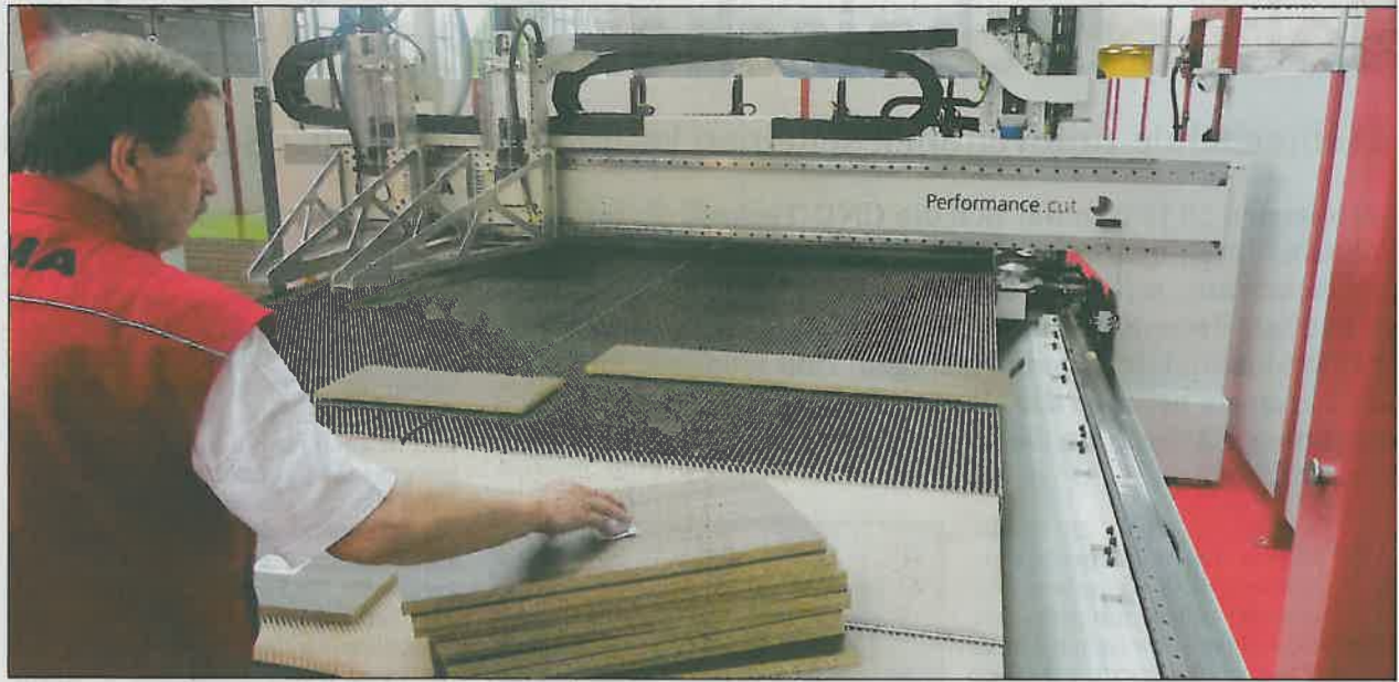
Das Aufteilzentrum „Performance Cut“ von Ima ist angelehnt an die Nesting-Technik.
