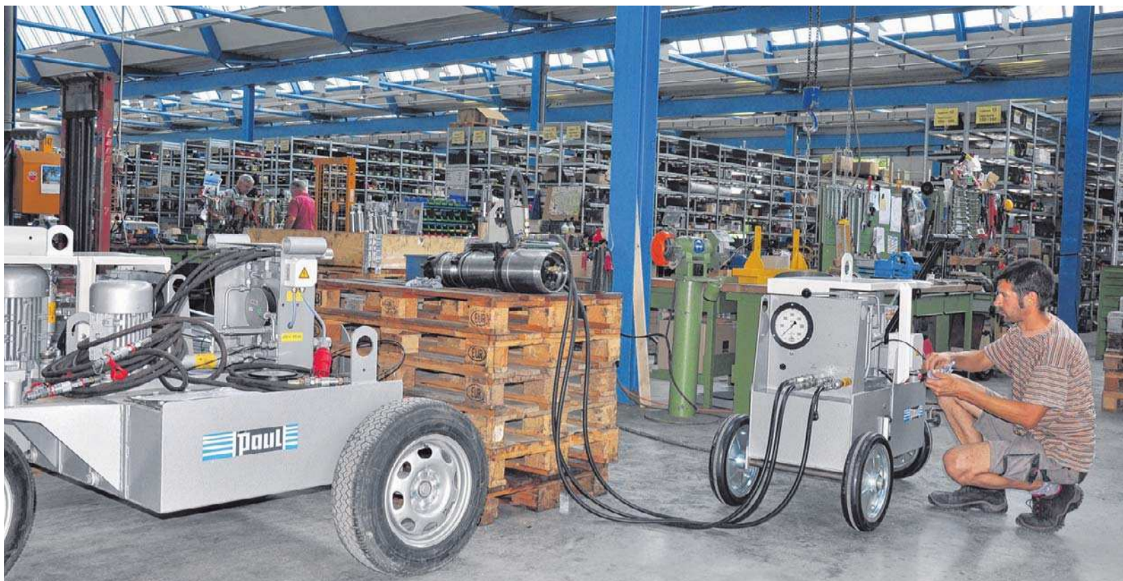
Endkontrolle und Einstellung der hydraulischen Pumpenaggregate für Nachspannarbeiten mit Bündelspanpressen.
