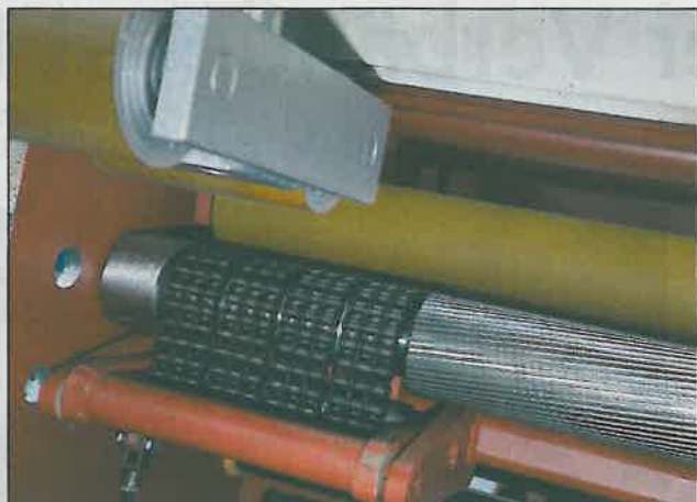
Eine Kombination aus Walzen und Kettenbett: Das Vorschubsystem der „Q-805“
