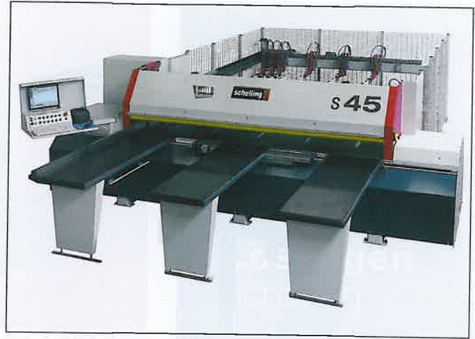
Mit der »s 45« (SCHELLING) lassen sich nicht nur Platten aufteilen, sondern auch mit Gehrungs- und Winkelschnitten versehen.
