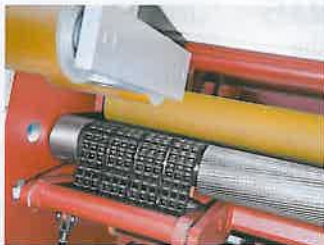
Q 805: Kombination aus Walzen- und Kettenvorschub
