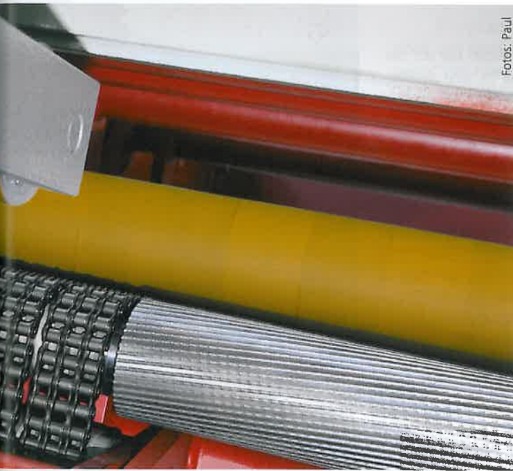
Oben: Das neue Vorschubsystem der Auftrennkreissäge „Q-805“ von Paul ist eine Kombination aus Walzen- und Kettenvorschub
