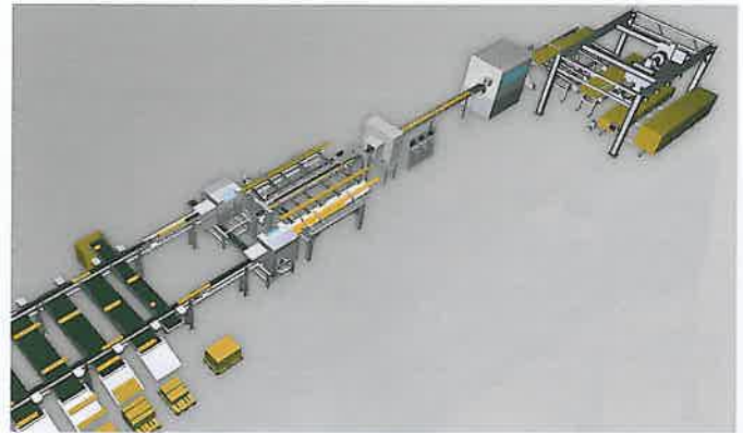
PAUL-Doppelkapplinie mit Vakuumentstapelung, Hobelmaschine, Paul-Wood-Scanning-System, zwei »C11«-Kappanlagen und Sortiersystem.
