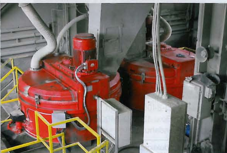
Insgesamt vier 1-m 3 -Planetenmischer sind bei Pekabex in Betrieb. Zwei alte Mischer, die schon einige Jahrzehnte ihren Dienst tun, sowie zwei neue Mischer von OMG
