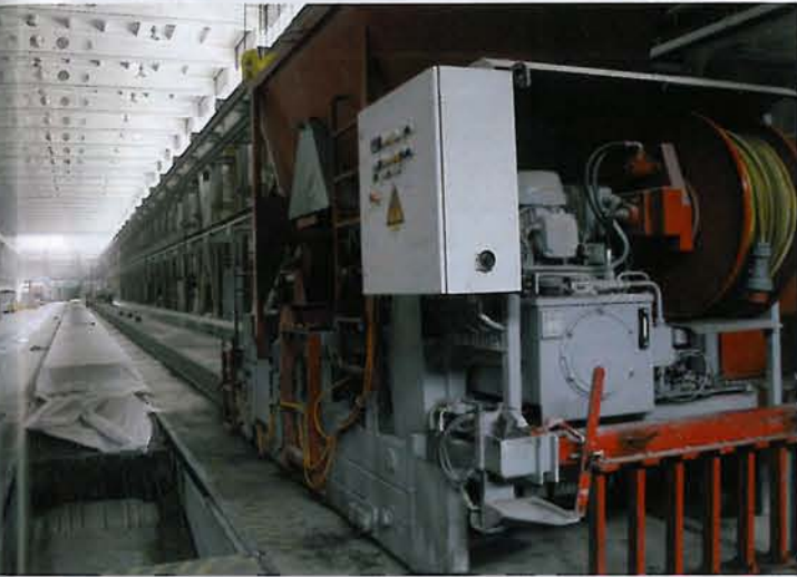
Zwei Echo-Gleitfertiger produzieren derzeit auf vier 120 m langen Spannbetten jährlich 150.000 m 2 Spannbetonfertigdecken
