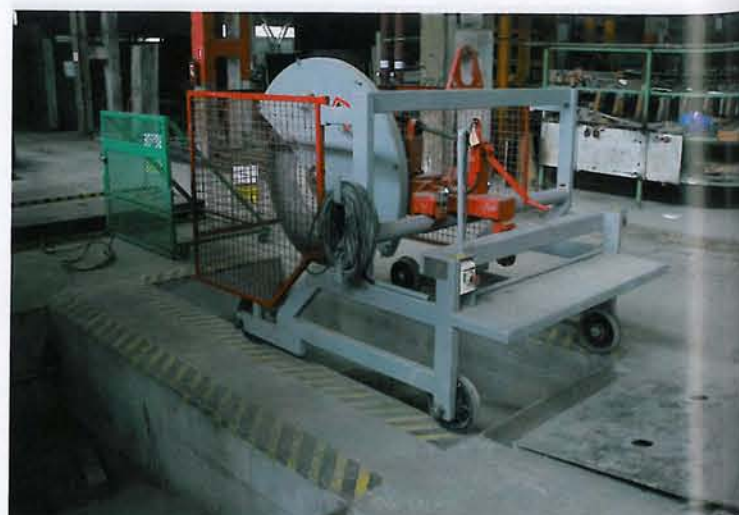
Die flexible Winkelsäge von Echo eignet sich für Schnitte unter beliebigen Winkeln, und die kleine zusätzliche Säge dient ausschließlich für Längsschnitte, wenn schmalere Deckenelemente benötigt werden.
