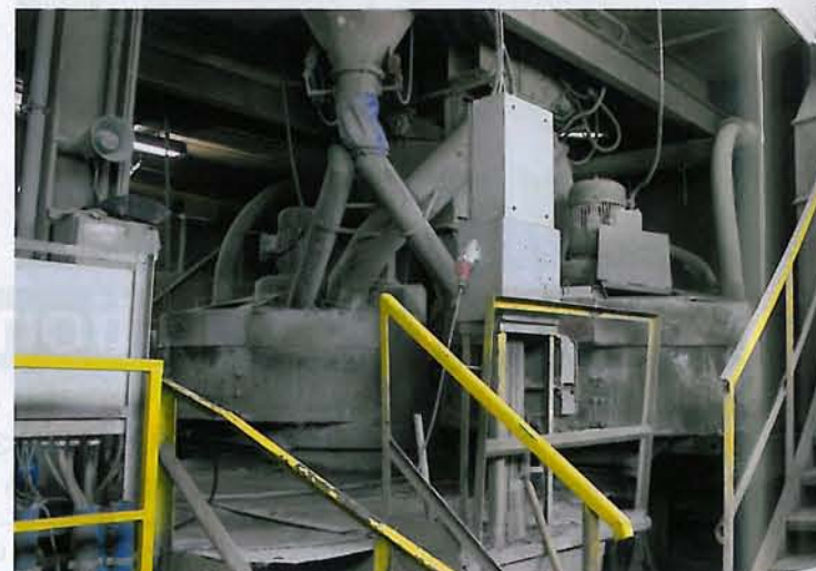
Insgesamt vier 1-m 3 -Planetenmischer sind bei Pekabex in Betrieb. Zwei alte Mischer, die schon einige Jahrzehnte ihren Dienst tun, sowie zwei neue Mischer von OMG
