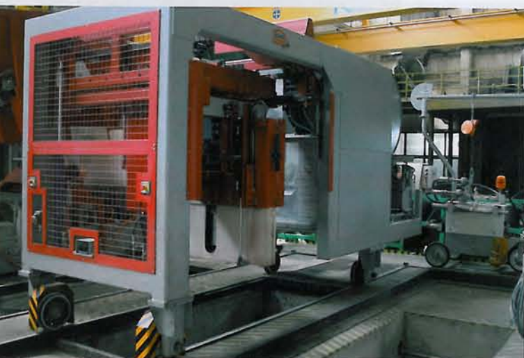
Die flexible Winkelsäge von Echo eignet sich für Schnitte unter beliebigen Winkeln, und die kleine zusätzliche Säge dient ausschließlich für Längsschnitte, wenn schmalere Deckenelemente benötigt werden.
