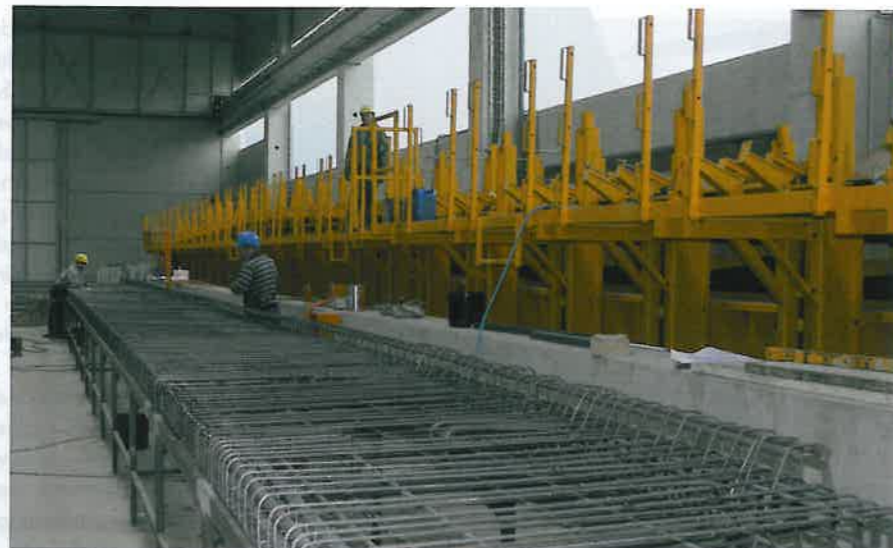
Die neue 55,00 m lange Binderschalung von Howal
