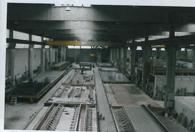
Blick auf die Kipptischfertigung bei Günther
