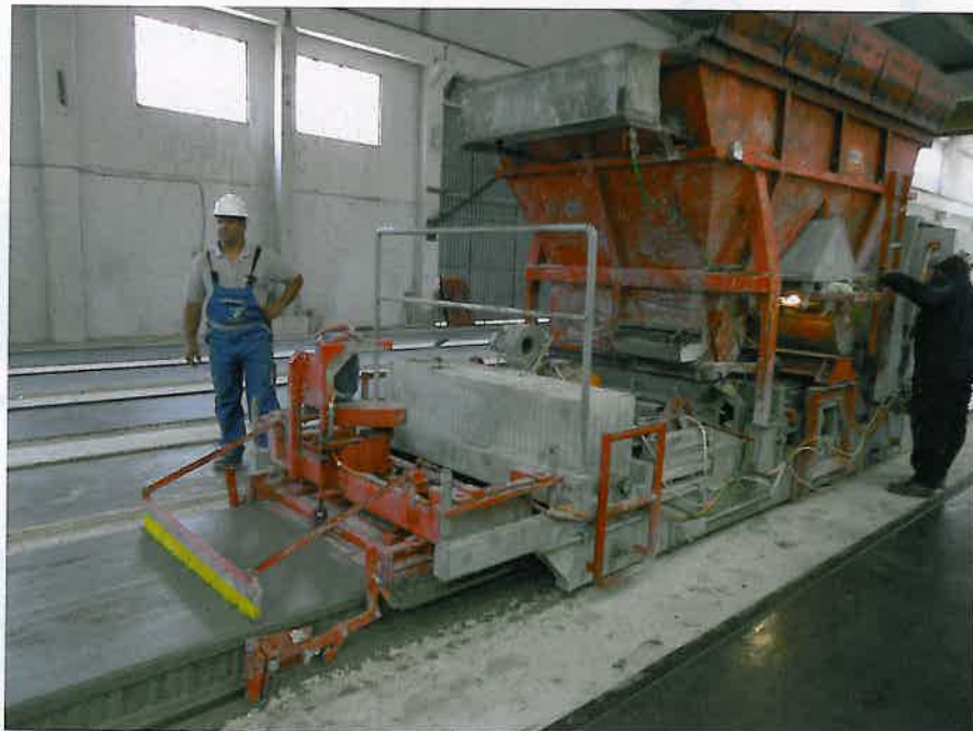
Im Produktionswerk von Top Element stellt ein Echo-Gleitfertiger, der mit der neuen Vorrichtung ausgestattet ist, Spannbetonfertigdecken mit wellenförmigen Schubverzahnungen an den Seitenrändern her.
