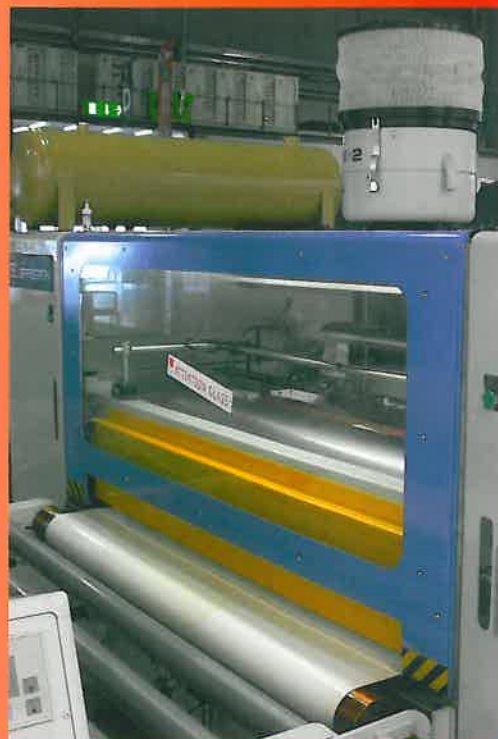
Rechts: Kleiberit demonstrierte sein Hot-Coating-Verfahren auf einer Anlage von Barberan
