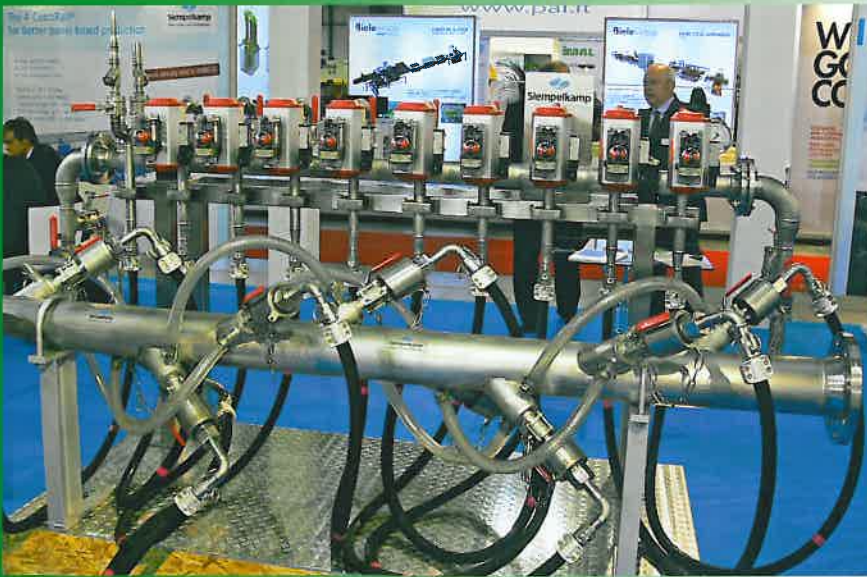
Stempelkamp zeigte eine neu entwickelte Beleimanlage für MDF
