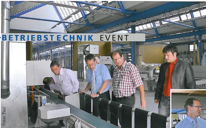
Verkaufsleiter Manfred Buck (Dritter von links) erklärt dem interessierten Fachpublikum die Optimierungsanlage zur vollautomatischen Produktion von Fensterkanteln
