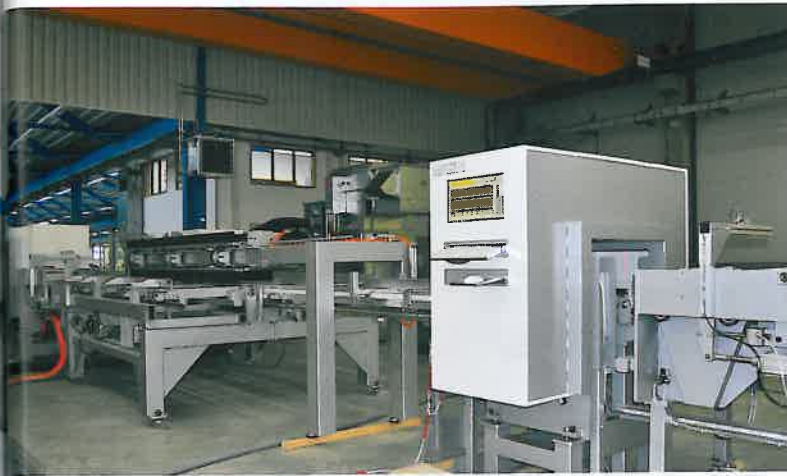
Die Anlage „Rapid Scan Duo“ besteht aus einem „Wood Scanning System“ und zwei CNC-Hochleistungskapplanlagen
