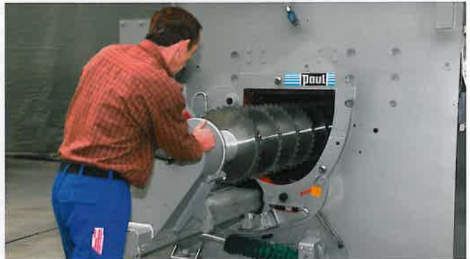
▲ (oben) Mehrblattsägen von Paul sind für den Zuschnitt von Platten aus unterschiedlichsten Materialien geeignet und werden ganz nach Kundenwunsch modifiziert angeboten (Fotos: Paul Maschinenfabrik) ▲ (unten) Die Maschinen sind alle sehr anwenderfreundlich, wie der einfache und schnelle Wechsel der großen Sägewelle bei der Modellreihe SK zeigt
