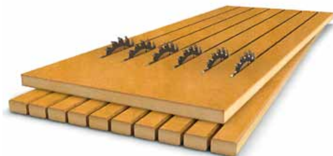
Schematische Darstellung: Auftrennen von Plattenmaterial mit Mehrblattsägen von Paul
