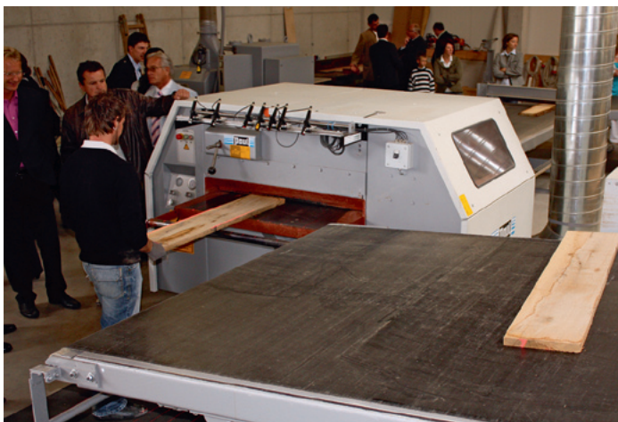
In Form gebracht: Unbesäumte Schnittware wird mit der Paul-Vielblatt-Kreisäge aufgetrennt
