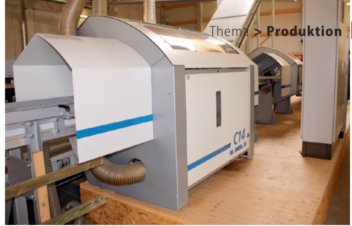
Hochleistungs-Kappsäge: C14 erkennt die Markierung und kappt die Ware längenoptimiert aus
