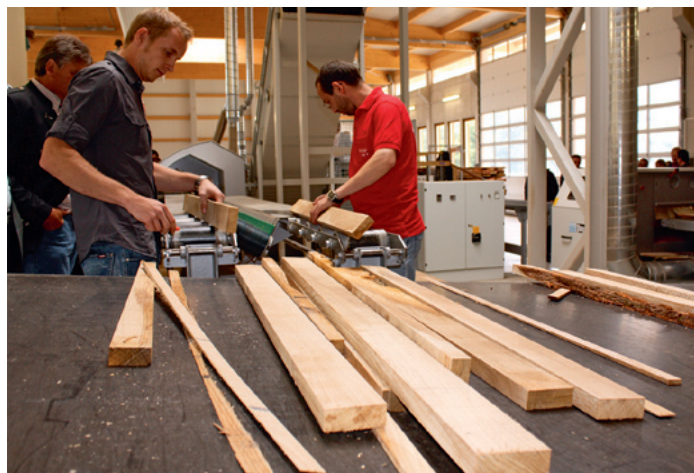
Aufgetrennte Ware kommt unsortiert (inklusive Spreißel) am Querförderer zu Mitarbeiter – Kappstellen werden mit Kreide markiert
