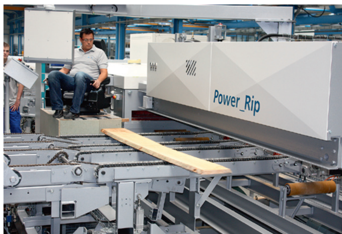
Vorführung der Zuschnitt-Anlage: Bediener legt vor der Vielblatt-Kreissäge die Qualitäten fest
