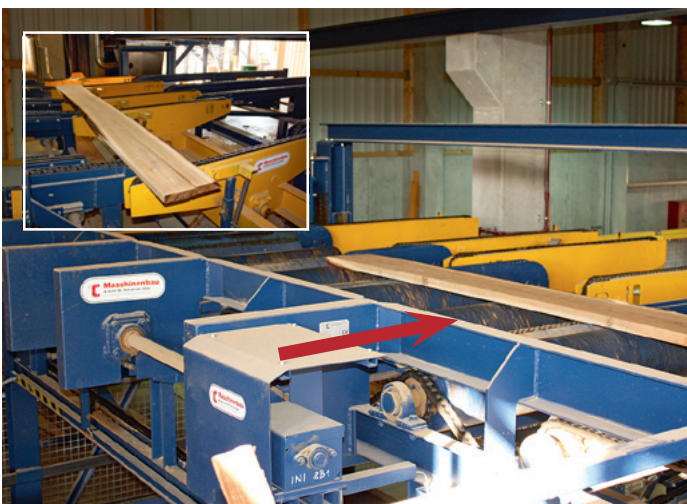
Schnittware hinter Bürstmaschine nach rechts auf Paternoster und wird nach unten transportiert; kleines Bild: rechts zum Stapeln, links zum Auftrennen
