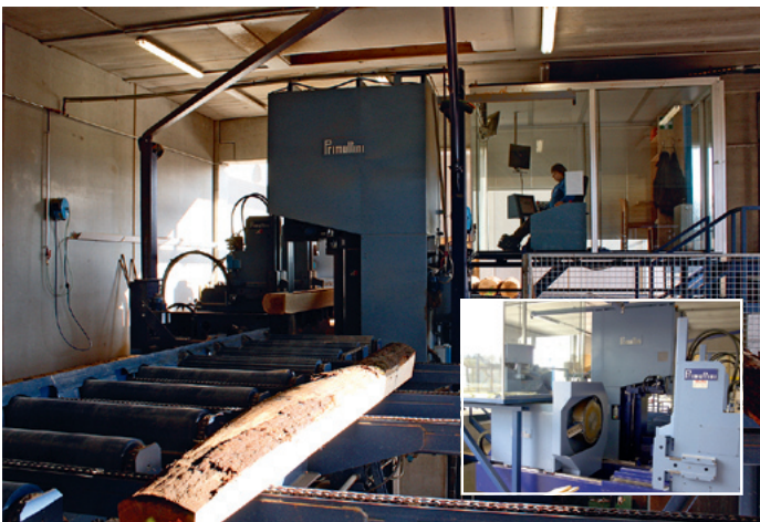
Primultini-Bandsäge mit Spaner und Spannwagen – rechts Möglichkeit der Wiederbeladung oder Fremdaufgabe
