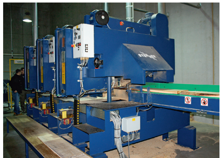
Dreifach-Horizontalbandsäge von Stenner: Mehrfachstärken werden mit Bandsägen Stoß an Stoß aufgetrennt
