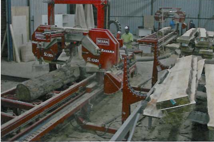
10 fm in der Stunde produziert diese Sägewerksanlage in Dubai mit zwei stationären Serra-Bavaria SL 130i innerhalb einer Produktionslinie
