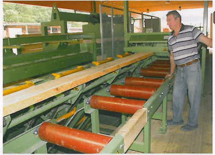
Seitenware gelangt über Lause-Vereinzelungsförderer zur Paul-Besäumkreissäge
