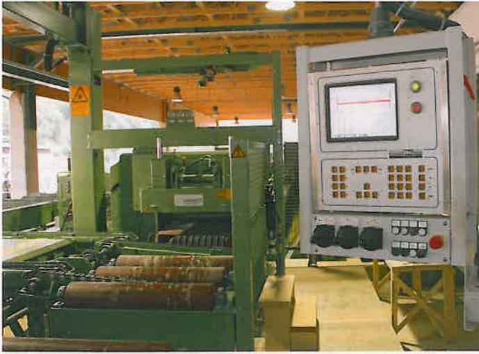
Am schwenkbaren Bedienpult werden alle Parameter für den Nachschnitt angezeigt
