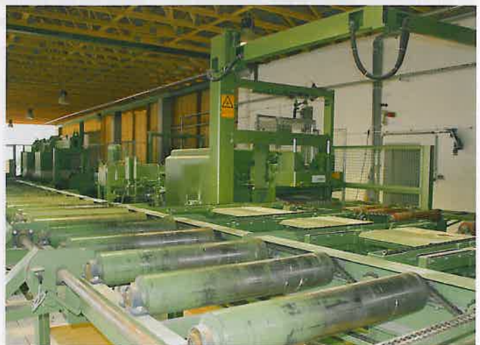
Rollengang hinter der Bandsäge , nach rechts geht's zur Nachschnitt-Kreissäge S900 von Paul
