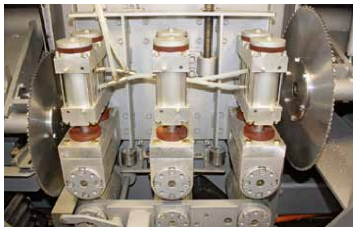
Doppelt hält besser – und ist schneller: Innenleben der Paul-Kappsäge Rapid mit zwei Kreissägeblättern
