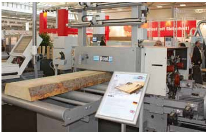
Neu im Paul-Programm ist die Besäum- und Auftrennsäge KME3 – eine solche Maschine wird im Sommer in der Steiermark installiert
