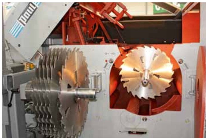
Bei der Modellreihe SGL sind die Sägewellen oben angeordnet und arbeiten im Gleichlauf
