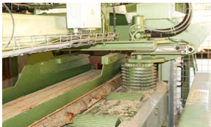
Auszug hinter dem Besäumer mit springendem Spaltkeil und hydraulisch synchron angetriebenem Schwartenauszieher
