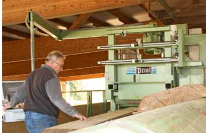
Über eine neue Zuführung von rechts gelangen Model und Brettware zum Einzugsstisch des neuen Doppelbesämers KME3
