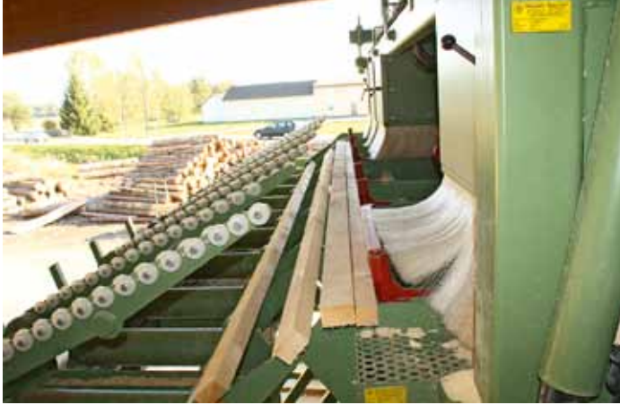
Querkappung von Mayrhofer für maßgenaues Schnittholz mit anschließender Sortierung
