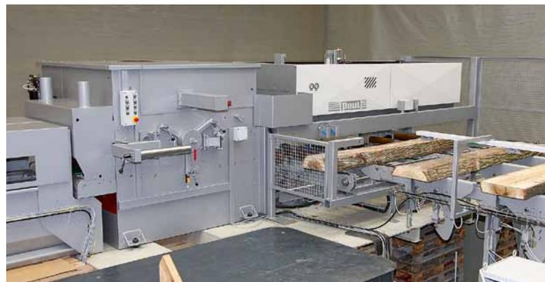
**Voll automatische Beschickung AB920** für Auftrennsägen
