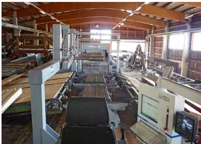
**Nachschnitt-Kreissäge SGL-1222** mit halb automatischer Beschickung
