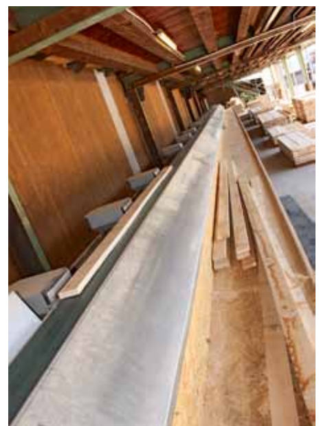
Ein 35 m langes Sortierband sorgt für die nötige Flexibilität bei der Einteilung
