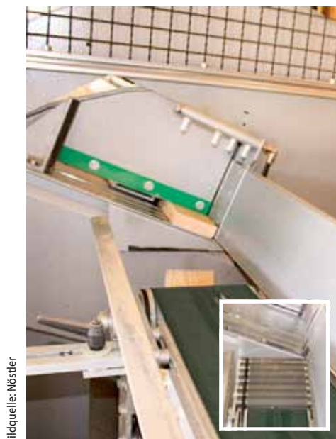
Die Reststücke werden über die Abfallklappe entsorgt – im kleinen Bild im geschlossenen Zustand
