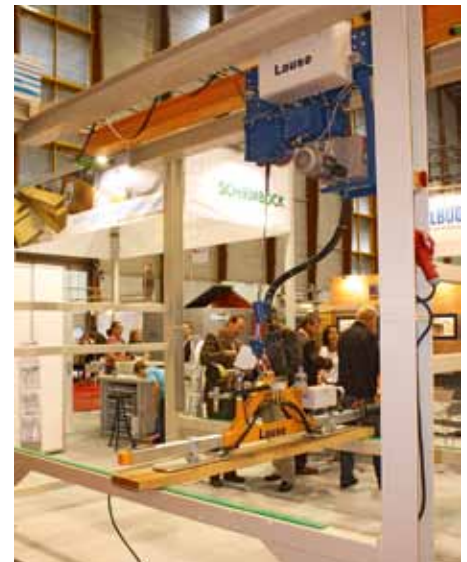
Lause-Vakuumhebergerät mit innovativer Antriebstechnik für die Hubachse
