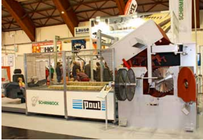
Vierstielig variable Paul-Nachschnittsäge SGL-1522 mit Schnitthöhen bis 225 mm
