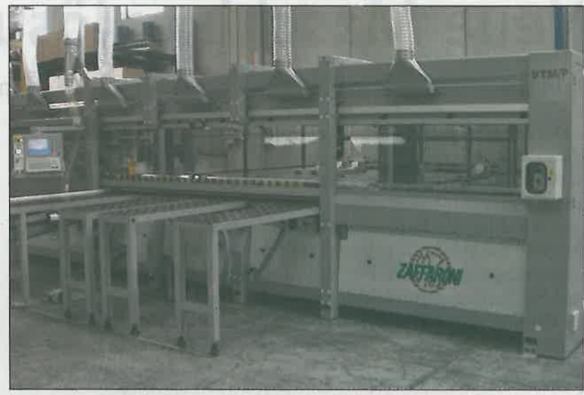
Mit dem Bearbeitungszentrum „STM“ des italienischen Herstellers Zaffaroni sind präzise „V“-Schnitte möglich
