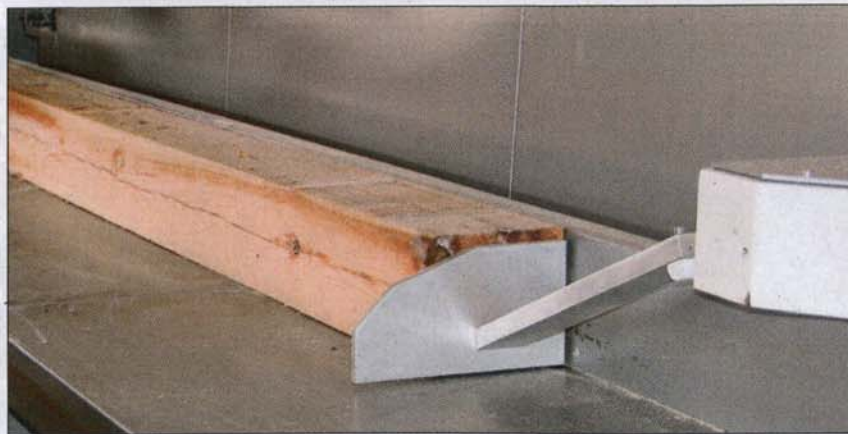
Ein Schieber führt einen 200×210 mm großen Balken der Kappsäge zu.
