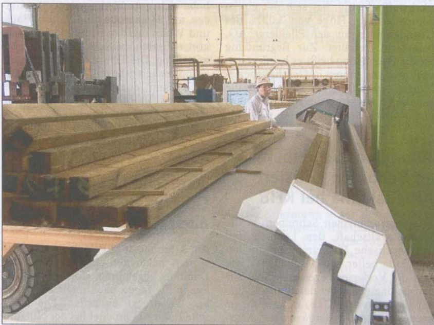
Eine Kappanlage des Typs „Push Cut CX“ beim Zuschnitt von Hölzern für Sichtschutzelemente.
